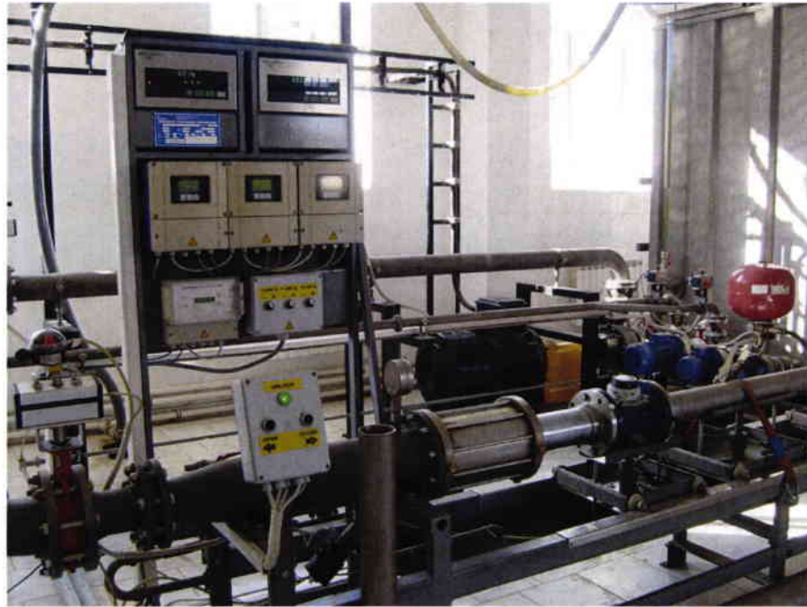
Պատկեր 75. Ստուգաչափման լաբորատորիա ջրաչափերի ստուգման և չափաբերման համար
