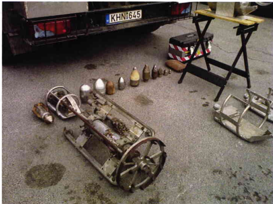
Պատկեր 100. Փոքր տրանսպորտի կայուն խողովակների մեխանիկական մաքրման հատուկ սարքավորումներ (Բուդապեշտ)
