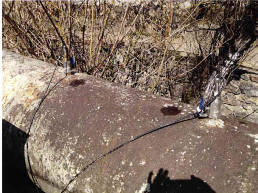
Պատկեր 71: Սարքավորումների ներդրումներ (ճնշման լոգերներ, ծախսաչափեր և այլն)
