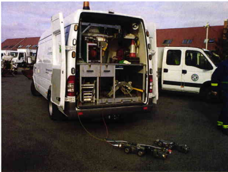
Պատկեր 79. Գեղտաջրերի ցանցի վերահսկման տեսախցիկ
