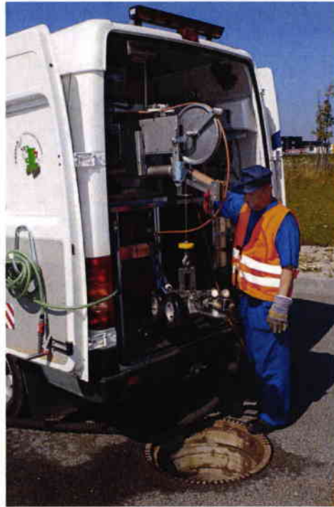
Պատկեր 98. Կեղտաջրերի ցանցի լիրաժեռ սարքավորված գննող մեքենա
