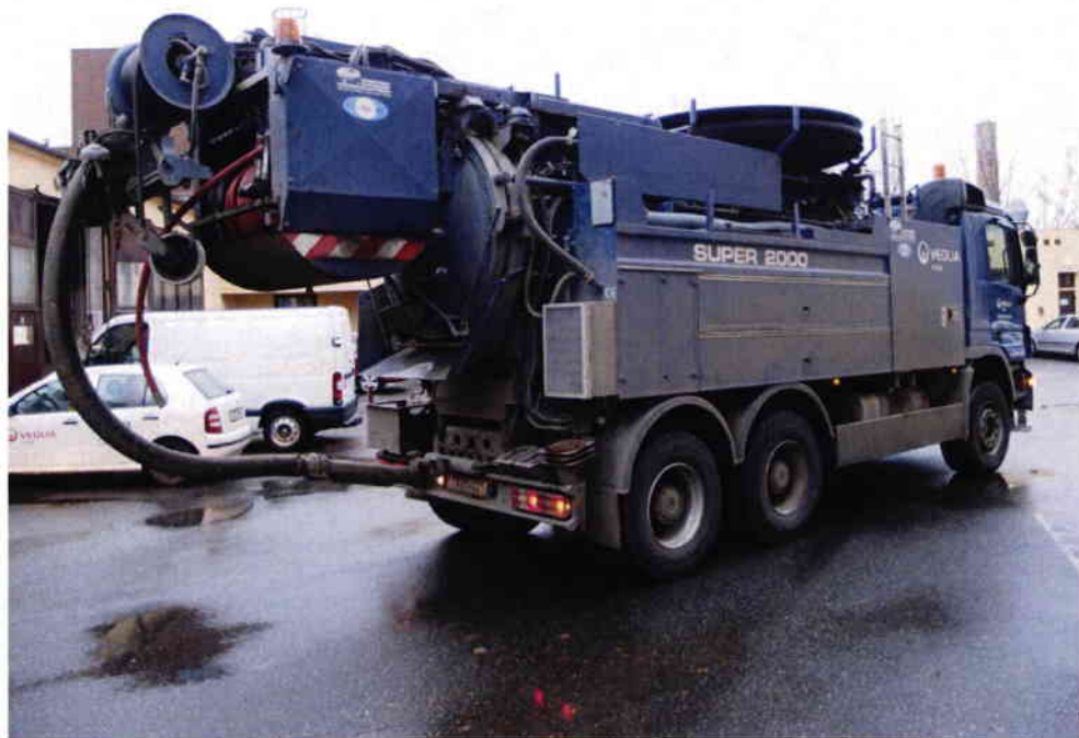
Պատկեր 99. Կեղտաջրերի ցանցի մաքրման հատուկ ճեշումային մեքենա
