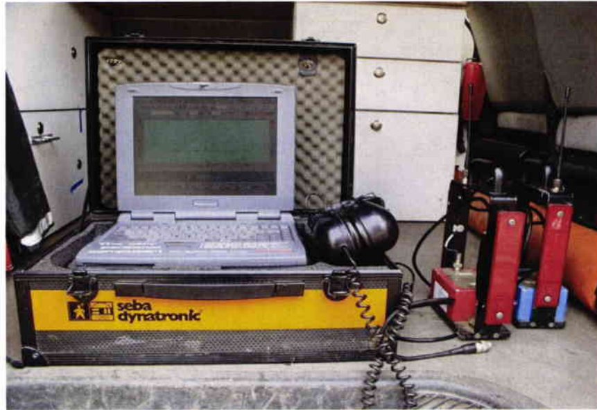
Պատկեր 94. Ժամանակակից կոռեկցիոն սարքի օգտագործում՝ ջրի հոսկարուստների հայտնաբերման նպատակով
