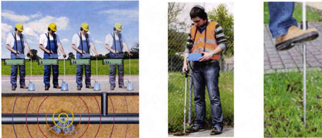
Պատկեր 103. Ճայնային հետազոտում գետնի բարձրախտով PAM W-2. Կոնտակտի հայտնաբերման համար կամ որպես գետնի լսաձող կիրառվող ճայնային ձող PAM T-3.
