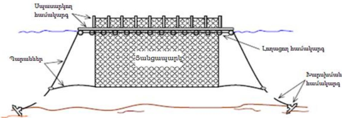
**Լողացող համակարգ:** Լողացող համակարգի մեջ մտնում են մետաղյա կամ պլաստիկե հենքը(каркас, drums), բարձր-խտությամբ պոլիէթիլենային խողովակները, ռետինե դողերը(rubber tires) և մետաղյա «կմախըները», որ ծածկվում են ձյութով կամ ապակեբամբակով(fiberglass): Վերջինի կիրառությունն ավելի նախընտրելի է, քանի որ այն կարող է դիմակայել շատ տարիներ, չնայած որ սկզբնական ծախսերը համեմատաբար բարձր են:
